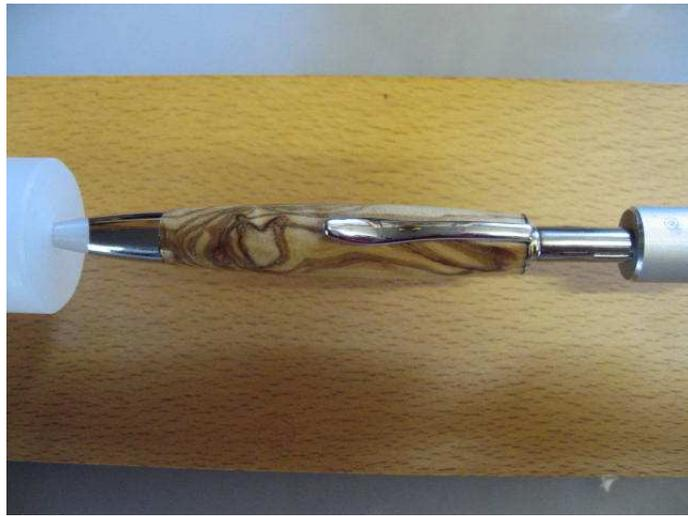
Nun die Mechanik (messingfarbene Seite zuerst) einpressen, lieber öfters kontrollieren, denn eine zu weit eingepresste Mechanik sorgt dafür, dass die Mine vorne zu weit herauschaut.
