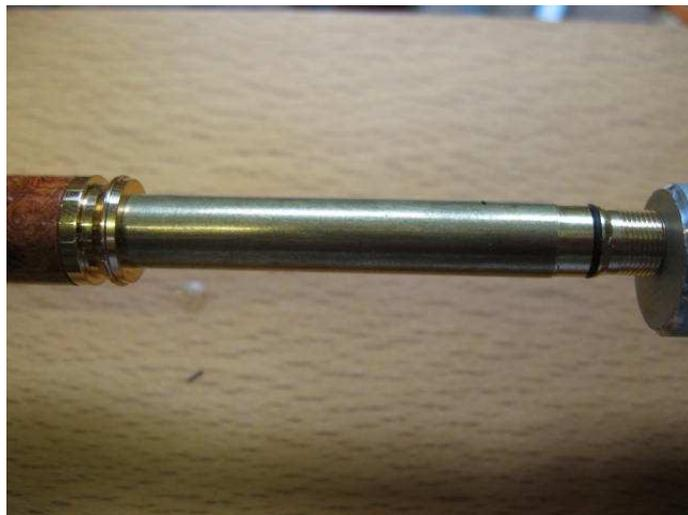
Nun führen Sie die Mine von vorne ein, Druckfeder aufstecken.
