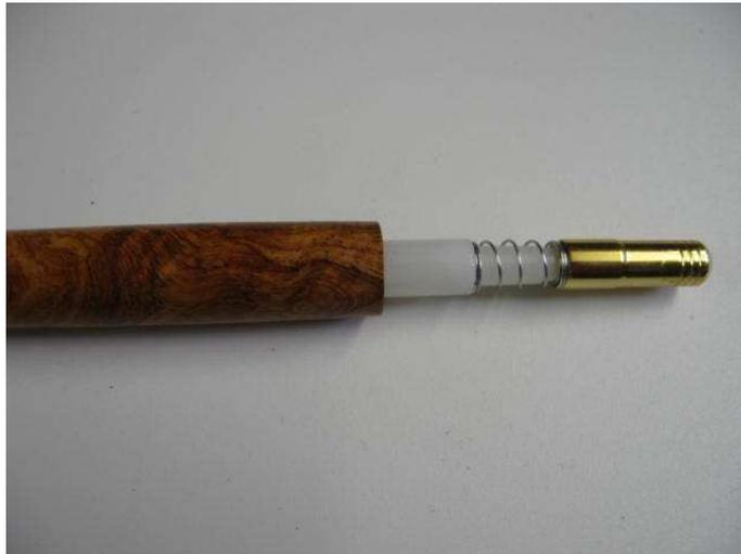
Achten Sie beim Einpressen des Endstückes **unbedingt darauf**, dass Sie ein Stück Holz mit einer Bohrung versehen verwenden, in dem der Klickmechanismus aufgenommen werden kann. Ansonsten wird beim Einpressen der Mechanismus beschädigt.
